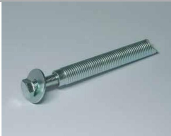
Le protezioni antiurto Indumetal assicurano una resistenza agli urti molto elevata anche grazie al sistema di fissaggio compreso nella fornitura. Le protezioni vengono fissate a terra, attraverso speciali bussole a filetto interno (M10 - M12 - M16) legate con ancoranti chimici ad iniezione.
